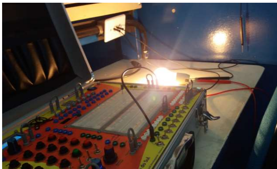
Figura 93 – Driver ativado em nível lógico "1" (5V)
