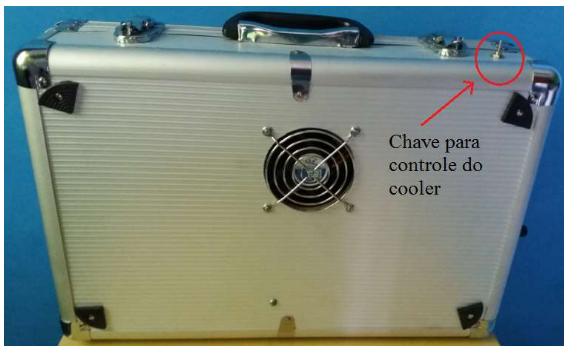
Figura 54 – Visão frontal – chave para controle do módulo cooler
