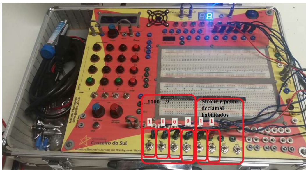
Figura 70 – Função Strobe e ponto decimal habilitados
