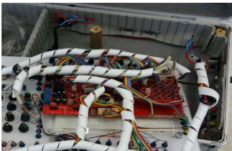
Figura 50 – Interligação da PCI a maleta
